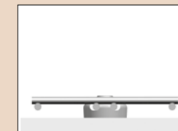
B30-I monterad på Distansbricka B22.
